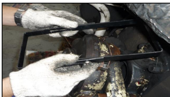
圖 24、安裝左右萬向節定位夾具
