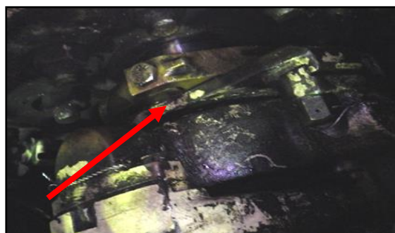
圖 16、最終驅動器突緣相嚙合
