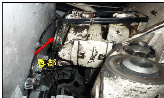
圖 27、萬向節唇部進入萬向節接合器導具
